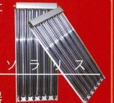
真空ガラス管とパラボラ型反射板を組み合わせることで、様々な角度からの日射に対して効率よく集熱することが可能です。熱媒を密閉回路で循環し熱交換する方式となっているため、循環ポンプの負荷は最小限です。また、集熱器単体は軽量であるため、設置箇所への負荷も僅かです。ソラリスを複数接続することにより、大規模な設備の給湯はかりでなく様々な用途に利用が可能です。
